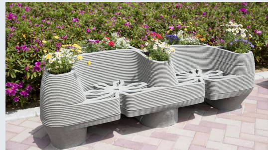
造形デザインコンペで受賞した学生のベンチをキャンパスに設置。セメント系3Dプリンターで造形しました
